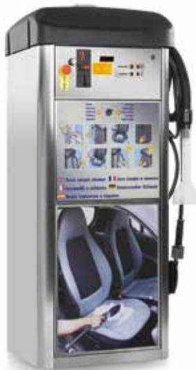
Lavasedili a schiuma, monofase e trifase. Il vantaggio di questa tecnologia consiste nella rapida asciugatura dei sedili (15-30 min.), confrontata con la tecnologia classica ad iniezione/estrazione d'acqua. Motore a tre stadi.
